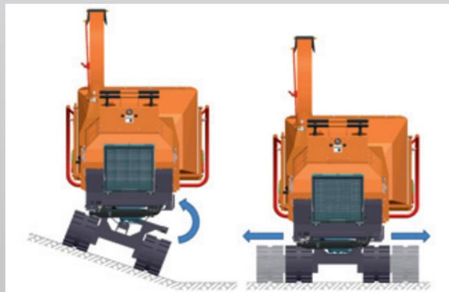
Les remblais abrupts de chemin de fer, les talus d'autoroute ou simplement la nécessité d'utiliser un broyeur de branches sur des terrains retirés inaccessibles à un appareil sur chassis routier ne constitue aucun obstacle à notre gamme de broyeurs sur chassis chenilles.
