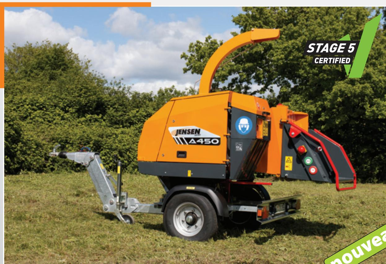
Avec son ouverture d'entraînement de 245 x 200 mm, le système « no-stress » et l'avancement électrique des rouleaux, cet appareil dévore littéralement des diamètres de bois jusqu'à 20 cm.
