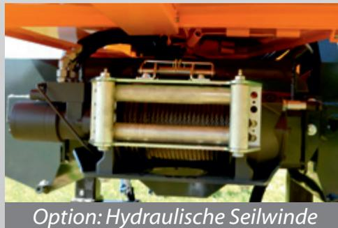
Option: Hydraulische Seilwinde
