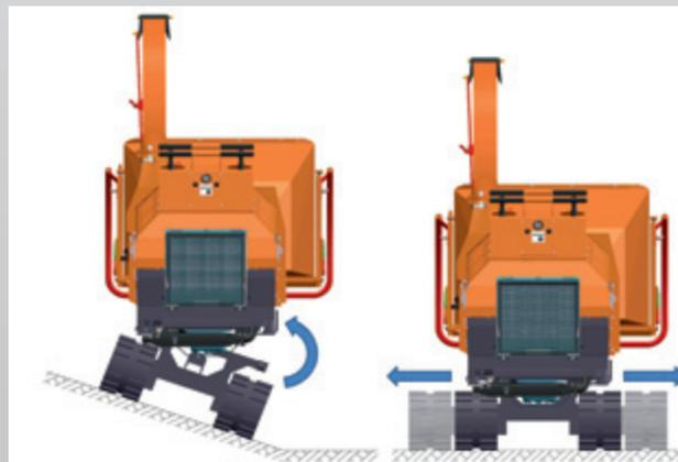
Egal ob Sie an Gleisanlagen, Autobahnböschungen oder auf schwierigem und steilem Gelände Arbeiten durchführen müssen, Sie kommen mit den Raupenhackern überall hin und können an Ort und Stelle Busch- und Stammholz zerkleinern.
