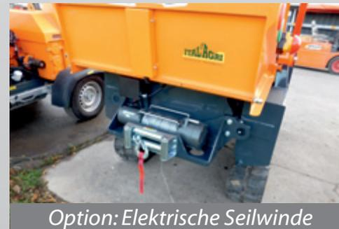
Option: Elektrische Seilwinde
