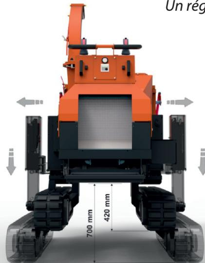
*Un réglage de la largeur du châssis de plus de 500 mm et une garde au sol jusqu'à 700mm garantissent la confortable utilisation de cet appareil, même dans les circonstances les plus difficiles.*
