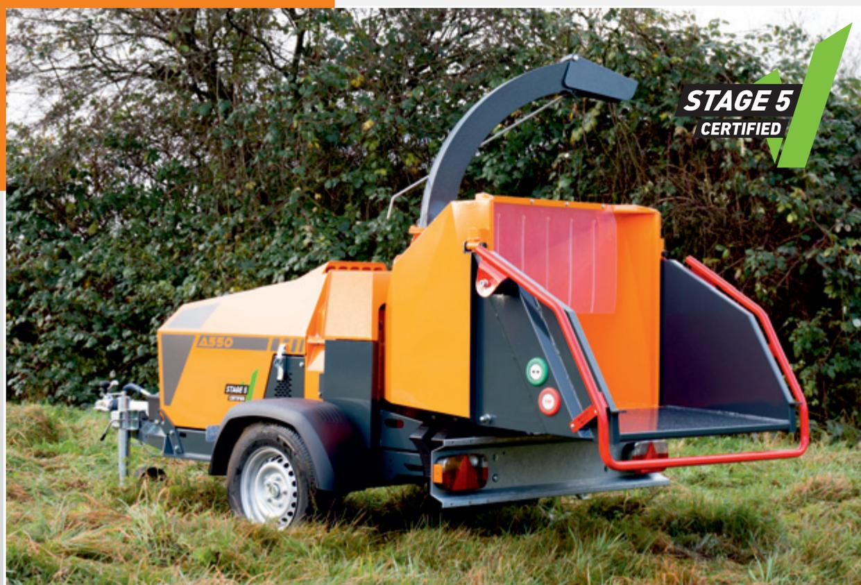
Grâce à l'utilisation d'un filtre à particules, le A550 reste écologique malgré son moteur diesel 27,2kW YANMAR.
