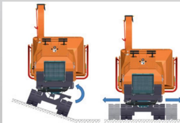
Les remblais abrupts de chemin de fer, les talus d'autoroute ou simplement la nécessité d'utiliser un broyeur de branches sur des terrains retirés inaccessibles à un appareil sur chassis routier ne constitue aucun obstacle à notre gamme de broyeurs sur chassis chenilles.
